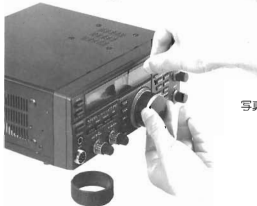
写真3 スプリングによりトルクを調整する
