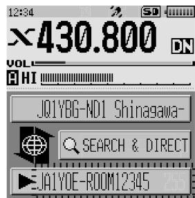
参考 「X」が点滅中に [X] キー短押しすると、再度ローカルノードへの接続を行います。
