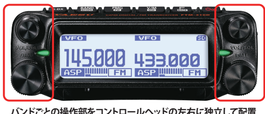
バンドごとの操作部をコントロールヘッドの左右に独立して配置
