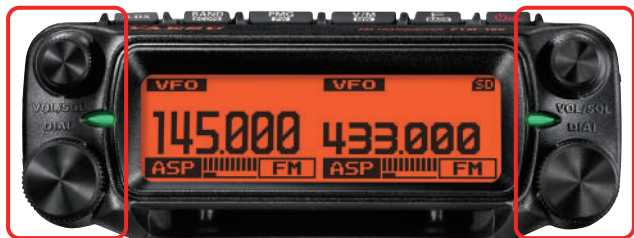
バンドごとの操作部をコントロールヘッドの左右に独立して配置
