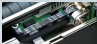
耐久性の高いシンクロベルトとHB型ステッピングモータ μ同調ユニット内部
