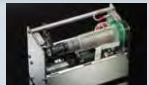
耐久性の高いシンクロベルトとHB型ステッピングモータ μ同調ユニット内部
