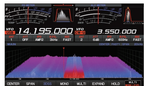
スパン変更による Narrow Band SDR 出力帯域拡大
