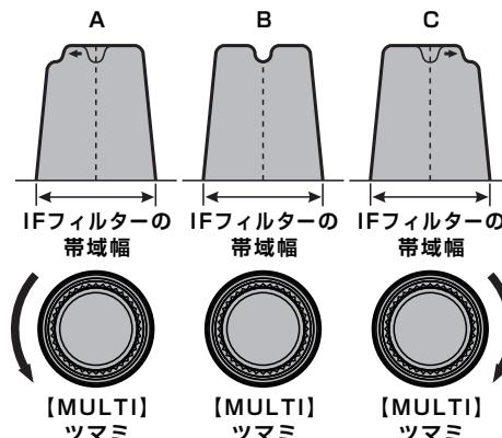
CONTOUR 回路は、DSP によるデジタルフィルターの通過帯域の中を、あたかも球体が動いているように曲線的にフィルターの形状を変化させて減衰部分を移動させますので、信号が突然カットされるようなこともなく、聴覚的に自然に妨害信号を減衰させて目的信号を浮かび上がらせる効果があります。
