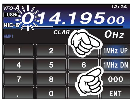
【1MHz UP】にタッチすると、運用周波数を 1MHz ステップで高くすることができます。また、【1MHz DN】にタッチすると 1MHz ステップで低くすることができます。
