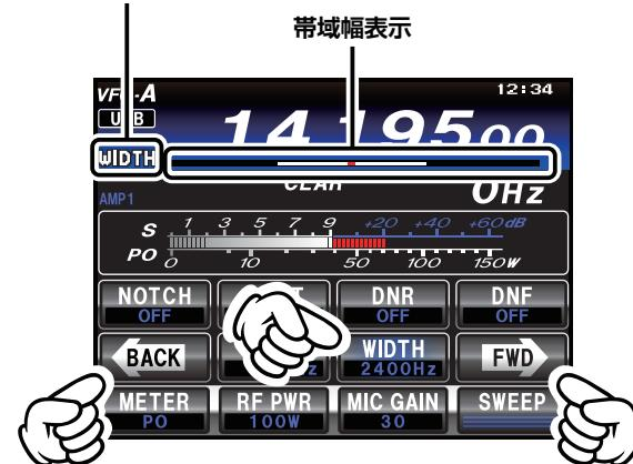
通常、図(B)に示すようにフィルターの帯域幅が標準である中央の位置で使用しますが、【MULTI】ツマミを反時計(左)方向にまわすと図(A)に示すようにフィルターの帯域幅が連続的に狭くなります。また、【MULTI】ツマミを時計(右)方向にまわすと図(C)に示すようにフィルターの帯域幅が連続的に広くなります。
