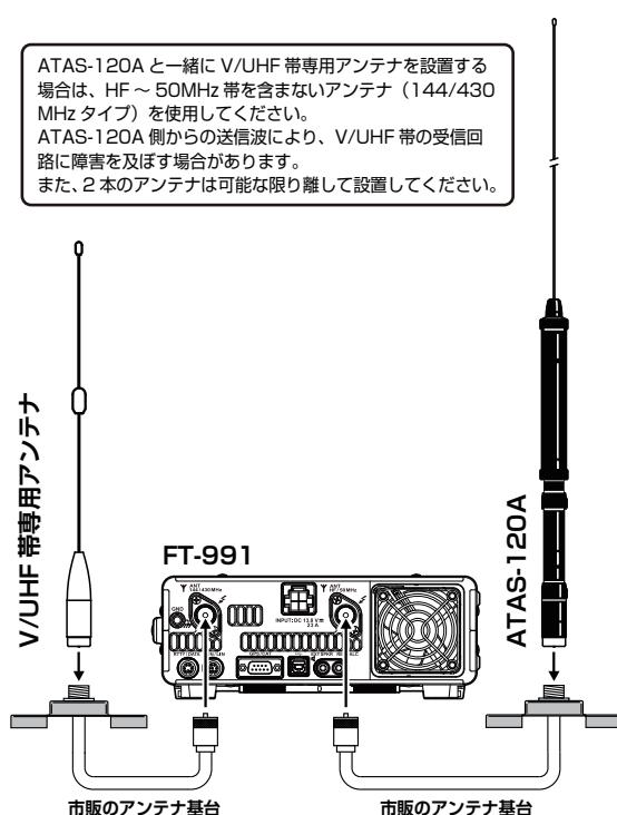
アンテナデュフレクサーを使用する場合は、ATAS-120A のコントロール電圧を供給するため、ATAS-120A の ANT 端子と本機の HF/50MHz ANT 端子は、直流的に接続され、さらにアース間と絶縁されている必要があります。
