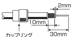
2. 心線にコネクターを通します。網組線部 分と心線部分をコネクターとハンダ付けをします。
