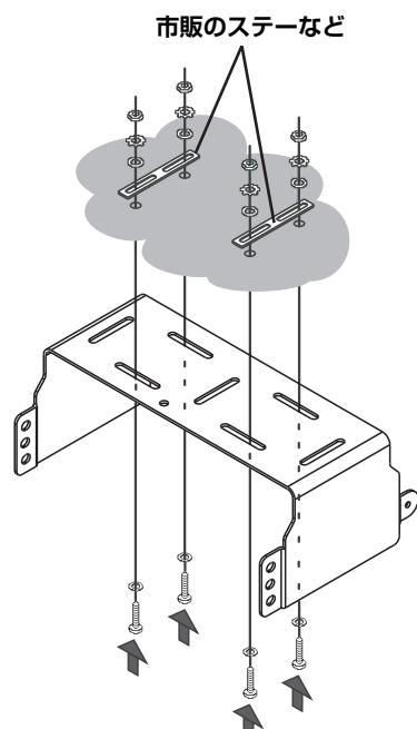
2. 付属のツマミビスを使用して、MMB-90 にトランシーバー本体を取り付けます。
