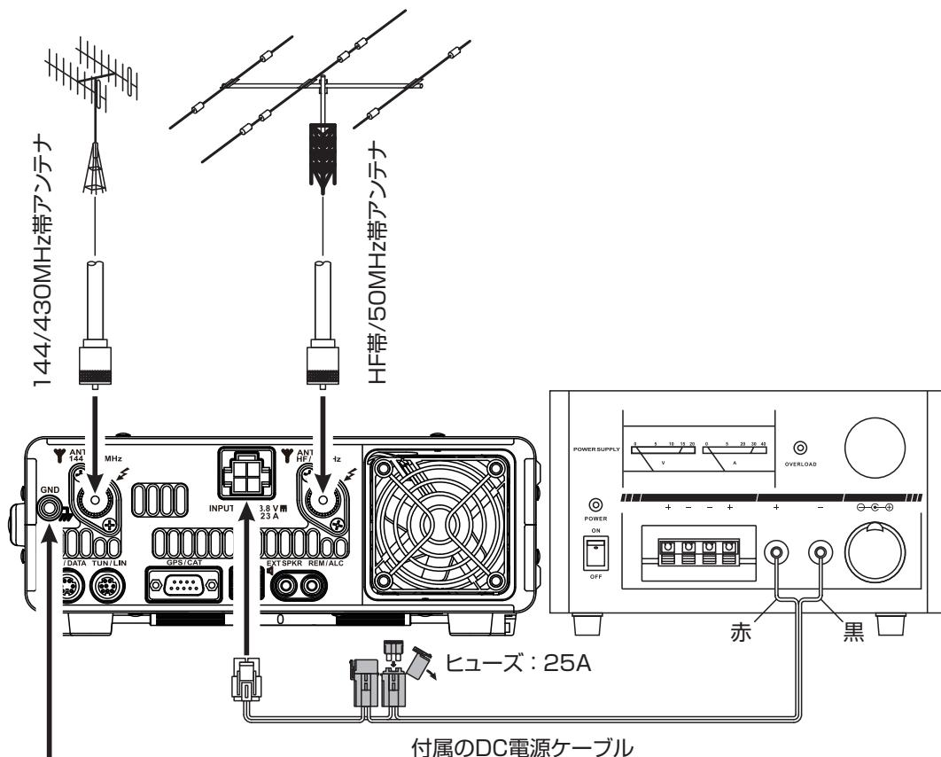
市販のアース棒や銅板などを地中に埋め、十分に太い銅線を使用して、できるだけ最短距離で、GND端子に接続してください。
