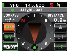
**COMPASS** コンパスの設定を表示します。自局の進行方向が上方となる「Heading Up」と北が常に上方となる「North Up」があります。切り替え方法は『コンパス盤の方向を変える』(P.91)を参照してください。
