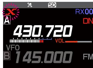
6. ローカルノードに接続すると“X”アイコンが点滅から点灯に変わり、接続先表示(画面の上段)にローカルノードの“ノード ID”と“都市名”が表示されます。
