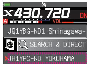
接続先表示の先頭に“▶”が表示されているときに、DIAL ツマミまわすと、自局が以前に接続したインターネット上のノードやルームのコールサインが点滅表示されて、選択することができます。
