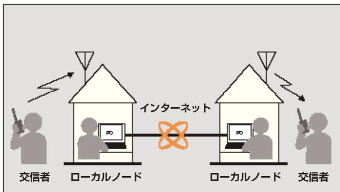
さらに、WIRES でデジタル通信に対応したのが WIRES-X です。従来のフォーンパッチ運用に加え、デジタル化されたテキストや画像、音声などのデータを送受信できます。
