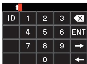
5. DTMF ID(5桁)を入力して、**【ENT】**にタッチします。
