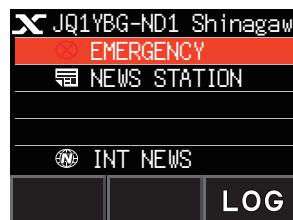
3. PTT スイッチを押すと、ビープ音が鳴って“EMG UPLOAD?”と確認画面が表示されます。緊急の情報を送る場合は、そのまま PTT スイッチを押し続けると、ビープ音が 3 回鳴った後に画面の表示が“UPLOAD”に変わり送信状態となります。マイクに向かってメッセージを話します。
