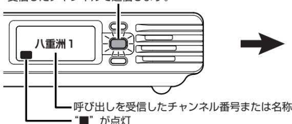
[P1] キーの点滅が点灯に変わると再びマルチチャンネル待受動作を開始します。
