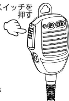
[P1] キーの点滅が点灯に変わると再びマルチチャンネル待ち受け動作を開始し
